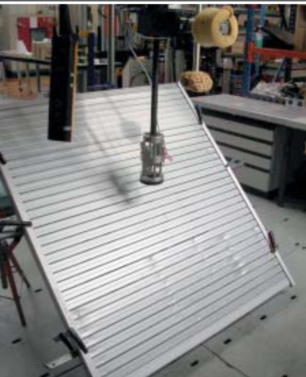
Bild 5 | Beschuss und Schadensbild eines Rafflamellenstores
